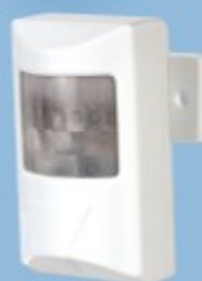
Sensor de presença de parede 100-240V 127V - 200W / 220V - 300W (Lâmp. fluorescente) 127V - 600W / 220V - 1100W (Lâmp. incandescente e halogena) cód. 28001 Caixa com 10 unidades cód. 28002 Caixa com 100 unidades
